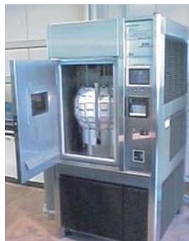
キセノン耐光試験機と紫外線照射試料
