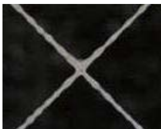
下地層なしで印刷した銀グリッド
