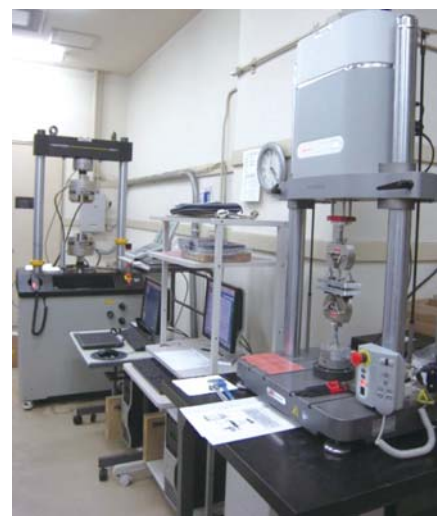
高速試験対応型疲労強度評価システム 奥側:高荷重対応機、手前側:低荷重対応機
